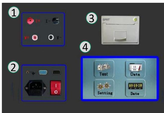
1. Terminales de entrada y salida de corriente (+I, -I) y tensión (V+, V-)
